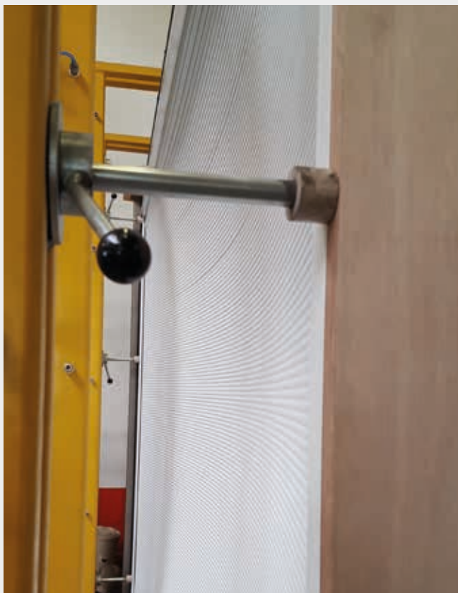
Conditions de test : Lame bioclimatique en alu, classe V*3, dimensions 3300 x 2250 h, coulisses alu VR013 avec joint AC040
