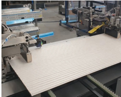
Machine pour la coupe et l'assemblage des tabliers de volets roulants en ALU
